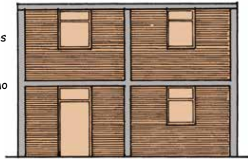
Vanos de ventanas y puertas bien ubicados
