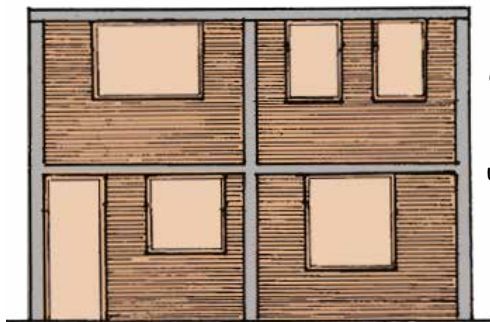
Vanos de ventanas y puertas mal ubicados
